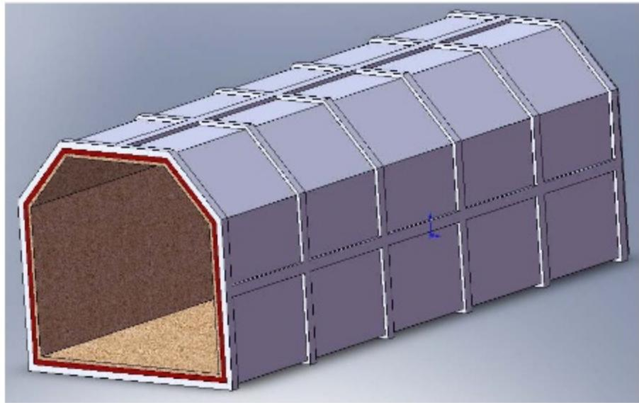
其外层为 6 毫米厚钢板，通过 60\*40 槽钢加固。外形尺寸：长 8.9 米，宽 2.7 米，高 1.9 米。有效体积 36 平米。中间夹层为隔热层，其备选材料如下表所示：
