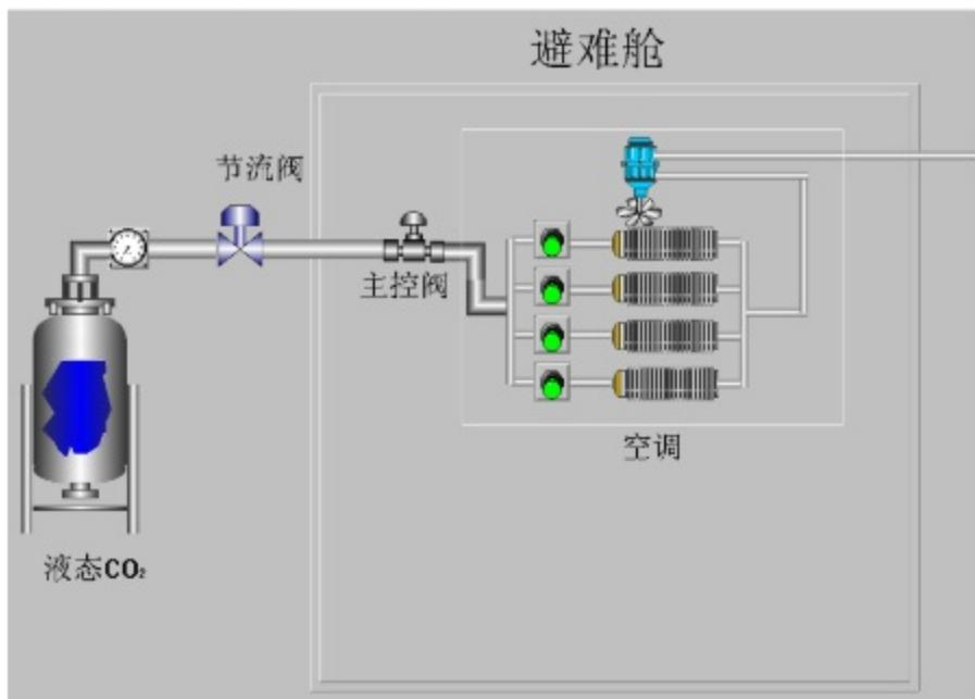
救生舱尾部的液态二氧化碳钢瓶通过直插入钢瓶内部的长管，在钢瓶内部 16MPa 气压的作用下，经过气压显示和气压调节装置进入避难
